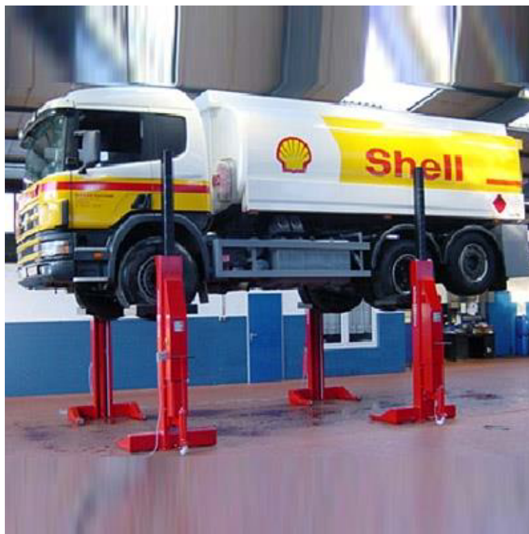
2.6 Сурет - Дөңгеленіп ақелінетін гидравликалық бағаналар FRG 7500
